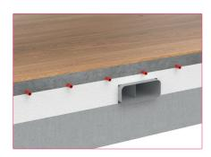
Unter-Estrich-Verlegung: COMPAIR STEEL flow® wird unter der Estrichschicht mit eingebauter Fußbodenheizung direkt in die Dämmschicht verlegt. Die Anforderungen an Schallschutz sind entsprechend den Nachweisen sicherzustellen.
